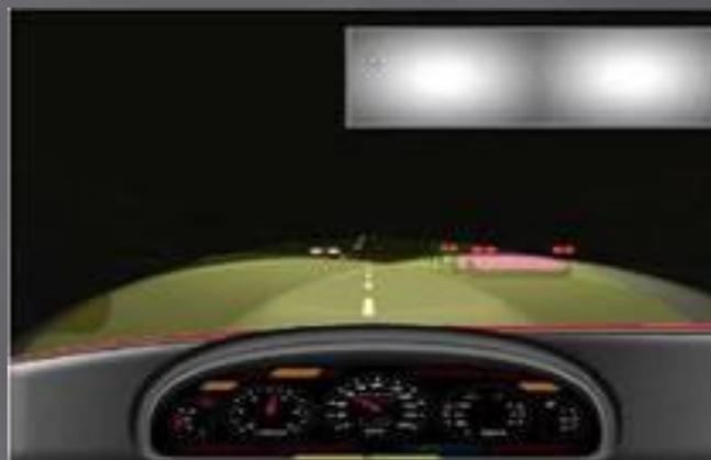
Программное обеспечение создает визуально-акустический эффект движения по дороге. Обучаемый водитель, воздействуя на органы управления, управляет движением «автомобиля», при этом он контролирует обстановку как перед собой, так и за собой (в зеркале заднего вида).
