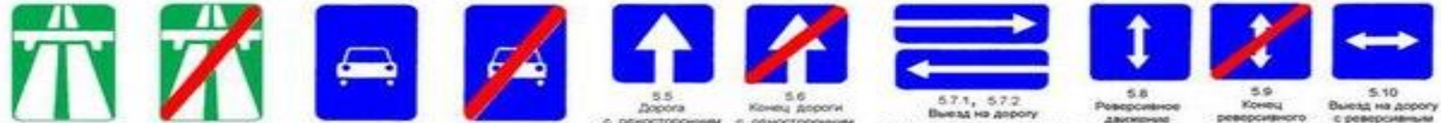
5.1 Автомагистраль, 5.2 Конец автомагистрали, 5.3 Дорога для автомобилей, 5.4 Конец дороги для автомобилей, 5.5 Дорога с односторонним движением, 5.6 Конец дороги с односторонним движением, 5.7.1, 5.7.2 Выезд на дорогу с односторонним движением, 5.8 Реверсивное движение, 5.9 Конец реверсивного движения, 5.10 Выезд на дорогу с реверсивным движением
