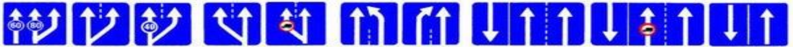
5.15.3 Начало полосы, 5.15.4 Начало полосы, 5.15.5 Конец полосы, 5.15.6 Конец полосы, 5.15.7 Направление движения по полосам
