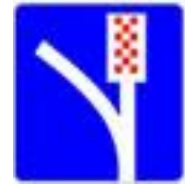
Знак 6.5. – Полоса для аварийной остановки
